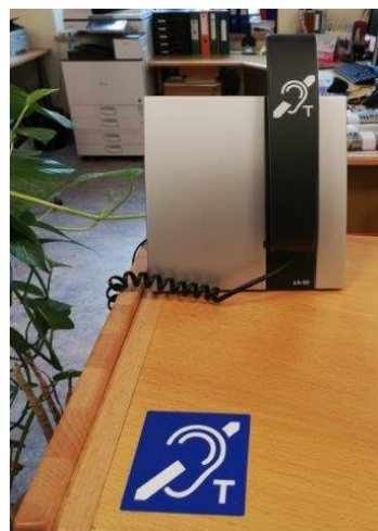
Abbildung 5: Kleine, mobile induktive Höranlagen sind ideal für Zweiergespräche, wie etwa in einem Bürgerservice.
